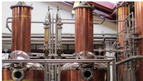
**Poli Distillerie si avvale di tre diverse tecnologie per la distillazione della grappa: tradizionale a vapore, a bagnomaria e a bagnomaria sottovuoto. Nell'immagine l'impianto bagnomaria tradizionale con caldaia a vapore.**
